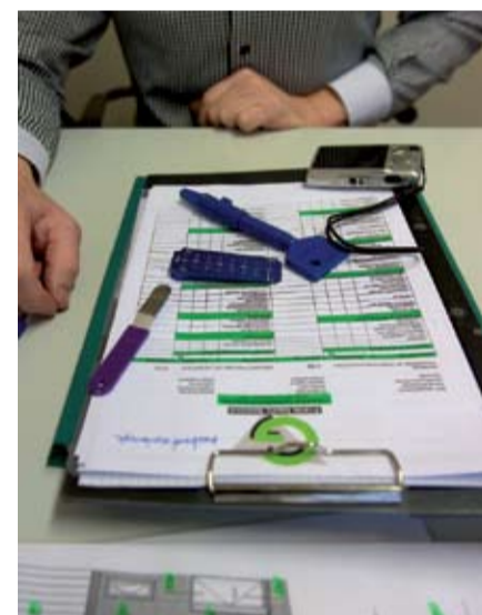
▲ Het standaard gereedschap voor een bouwplaatsinspectie geveltimmerwerk: digitale camera, bouwsleutel, voelmaat (onder andere voor het constateren van de hieldichting op de glaslat) en deurwig (om de omtrekspel van een deur te bepalen). Niet op de foto: de houtvochtmeter.
